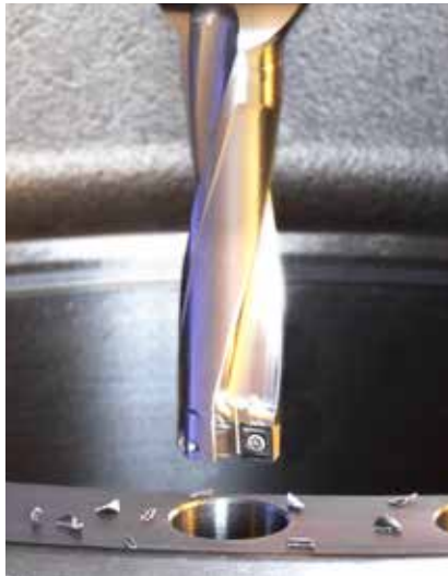
Рис. 27 Сверло DR со сменными пластинами
