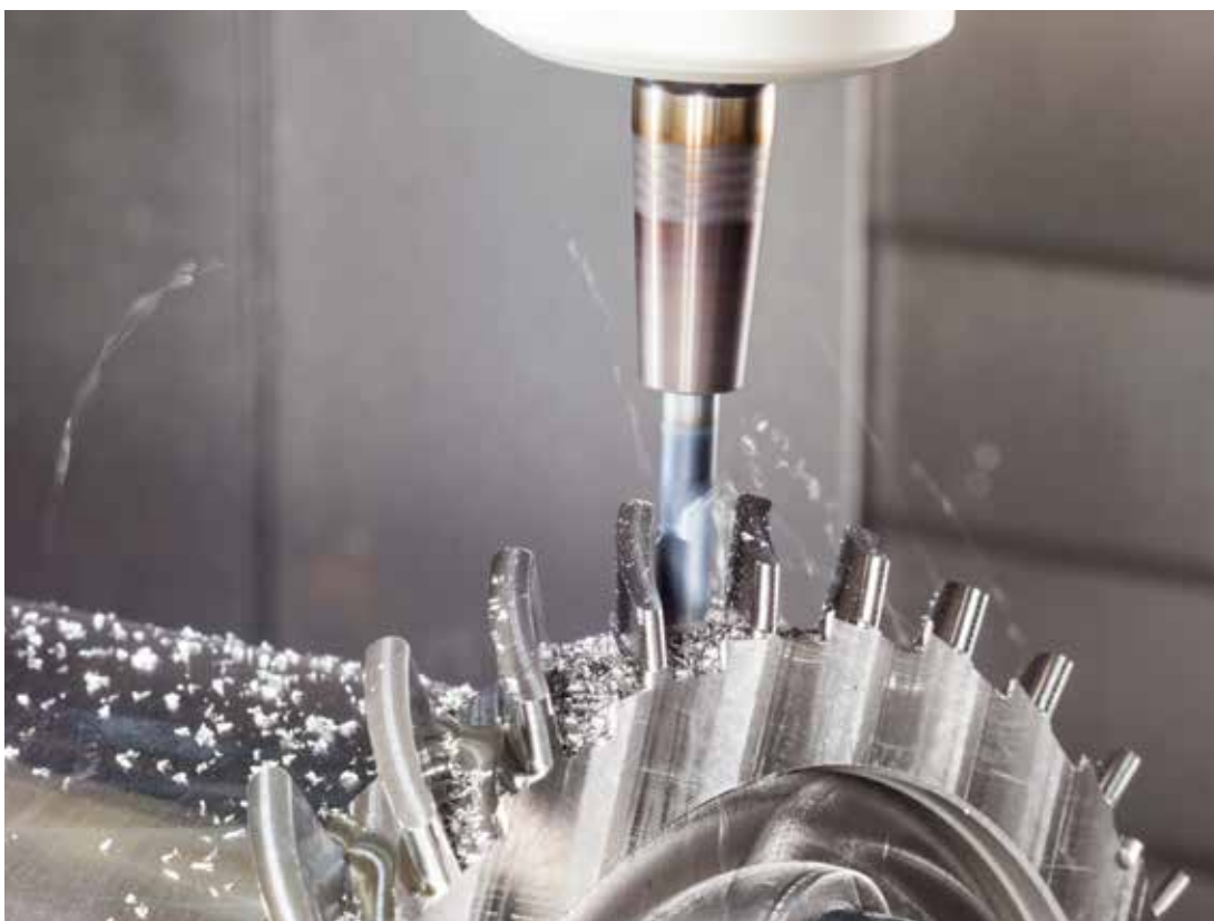
Рис. 25 Фрезерование диска с лопатками
