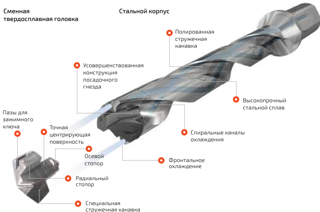
Рис. 29 Конструкция сверла SUMOCHAM
