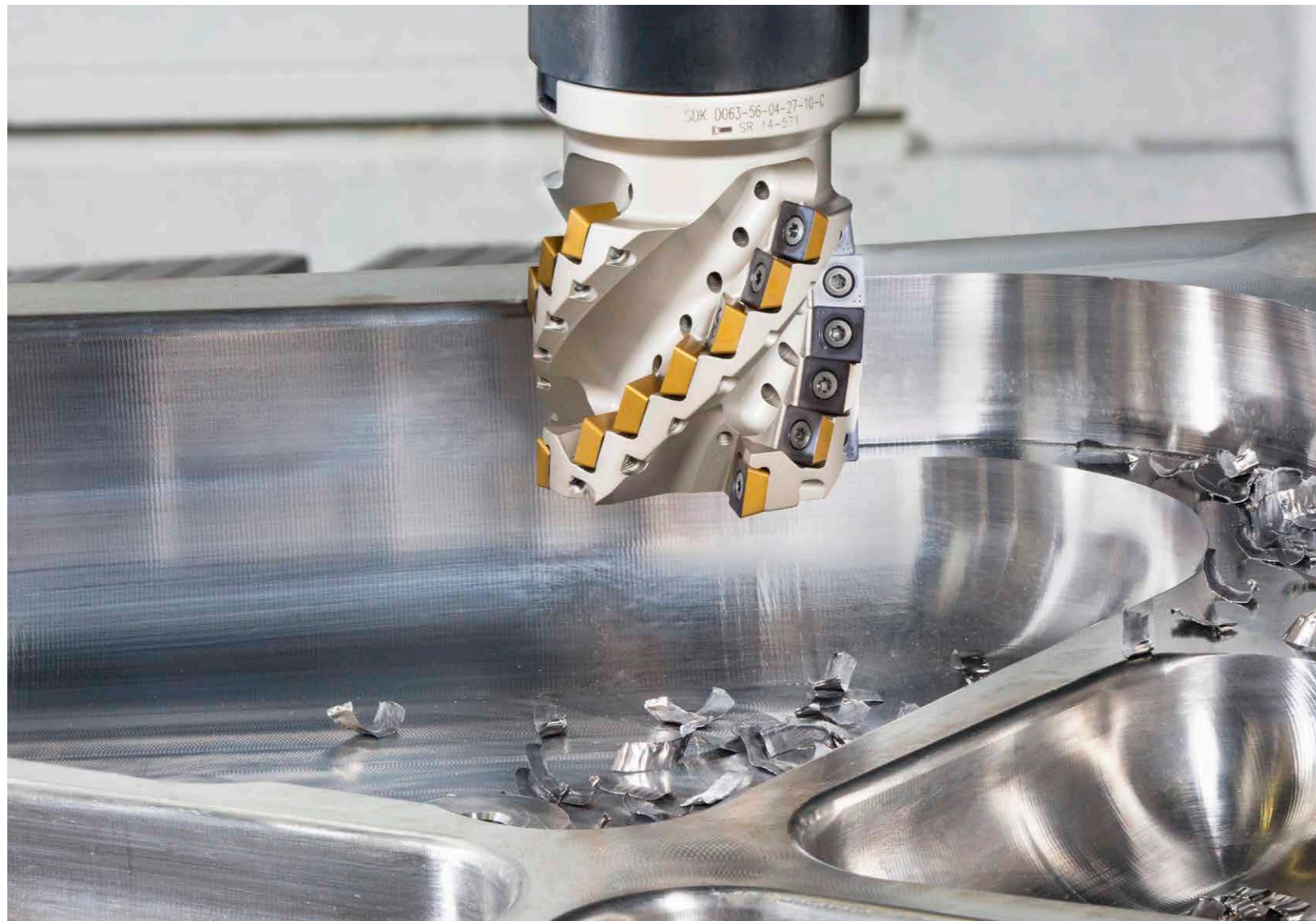
Die neuen Aufsteckfräser der HELIQUAD-Serie von ISCAR mit verlängerter Spannutt erzielen bei der Titan-Bearbeitung sehr gute Oberflächenqualitäten.
