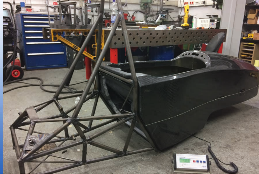
Der einsitzige Flitzer besteht aus einer besonders leichten Monocoque-Konstruktion.
