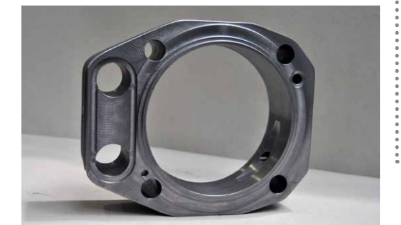
Neben der Einhaltung von Form- und Lagetoleranzen wurde auch die Oberflächenqualität verbessert.
