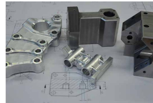
Mit dem neuen Fräser werden verschiedene Werkstücke wie Anbauteile für hydraulische Spannvorrichtungen und Führungsaufnahmen für den Maschinenbau bearbeitet.
