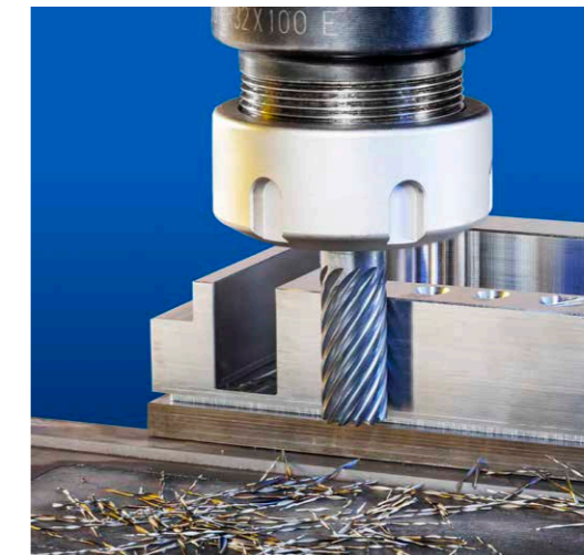
Die Serie Ti-TURBO von ISCAR umfasst Hartmetallfräser mit sechs bis 20 Millimeter Durchmesser. Sie wurde für die Schlicht- und Hochgeschwindigkeitsbearbeitung von Titan entwickelt.
