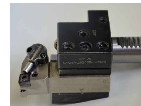
Die Märkische Schraubenfabrik setzt die ISCAR-Lösung mit dem Grundhalter VDI25 ein.
