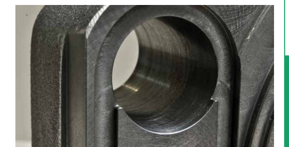
Neben der Einhaltung von Form- und Lagetoleranzen wurde auch die Oberflächenqualität verbessert.
