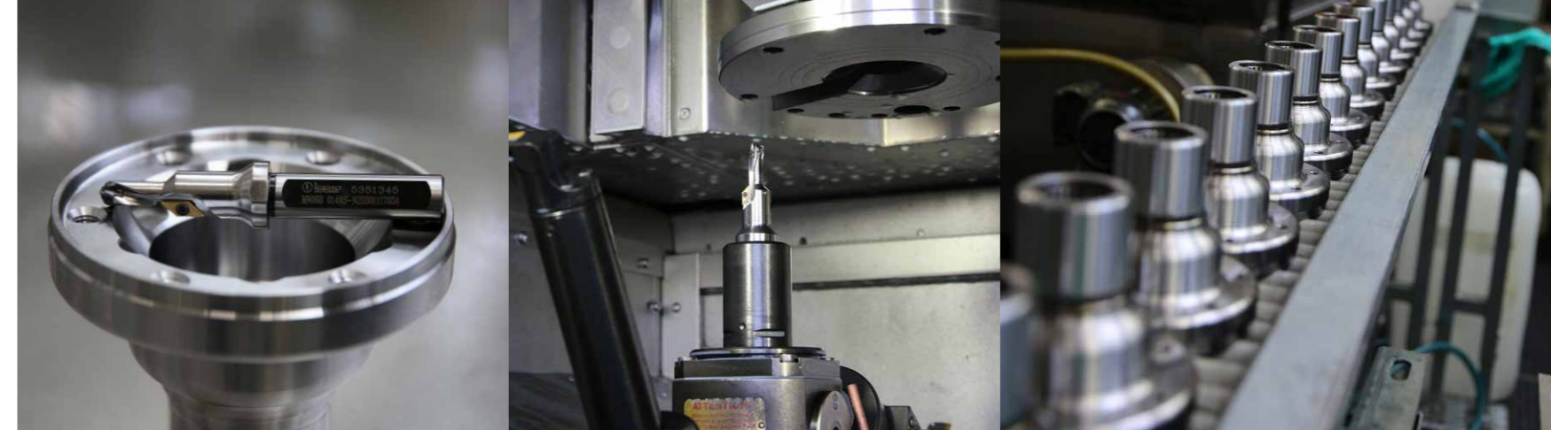
Das Kombinationswerkzeug von ISCAR sorgt für eine prozesssichere Kernlochbohrung für Gewinde M8 samt Senkung. Die Vorzüge des SUMOCHAM – höchste Präzision bei geringsten Nebenzeiten – kommen dabei voll zur Geltung.
