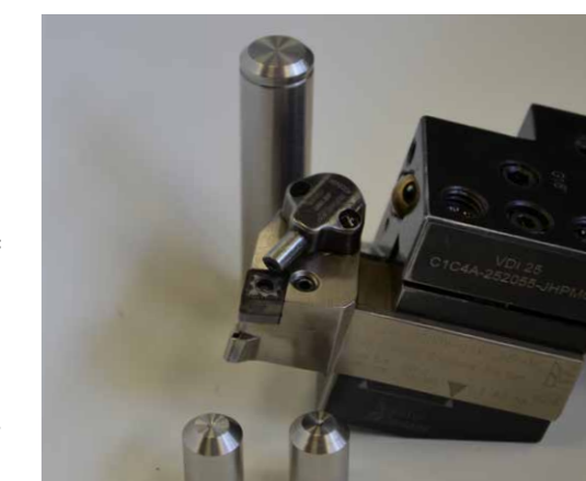
Mit Einsatz des Drehwerkzeugs der JET HP-Linie von ISCAR haben sich die Standzeiten bei der Bolzenproduktion verdoppelt.
