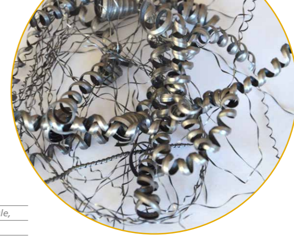
Lange Späne, die sich verkeilen und den Maschinenraum schnell verstopfen, gehören der Vergangenheit an.
