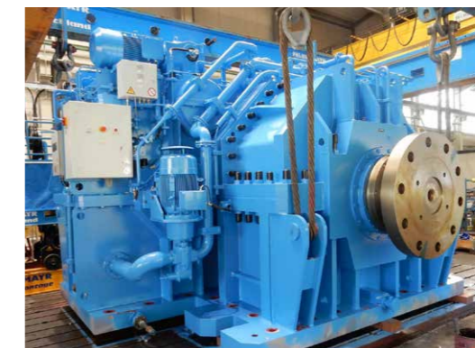
180 Tonnen wiegt das Getriebe, das Keller an einen Kunden in China ausgeliefert hat. Der Koloss arbeitet künftig in einem Baggerschiff.
