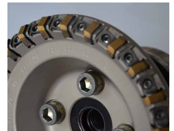
Die Wendeschneidplatten sitzen fest und formschlüssig. Dies sorgt für einen stabilen Bearbeitungsprozess.
